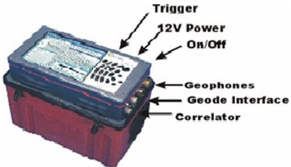
Hình 4. Máy đo địa chấn 48 kênh STRATAVISOR NZ.
