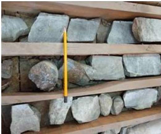
Ảnh 7: Đới khoáng hóa urani chứa molybden, LK3 khu vực Kon Rá, độ sâu 14,0-14,5 m
