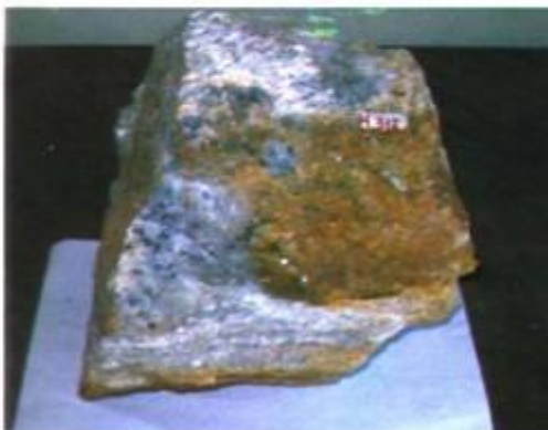
Ảnh 5. Casiterit trong đá biến đổi greisen hoá gặp tại hào H.312 [6].
