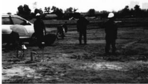
Hình 7. Lỗ khoan nằm giữa geophone 12 và 13 trên tuyến đo MASW. Lỗ khoan được dùng trong khảo sát địa chấn lỗ khoan (down-hole) và xác định thành phần thạch học, mật độ đất đá thuộc khu vực dự án khu công nghệ cao, Quận 9, Tp. Hồ Chí Minh (ảnh chụp ngày 9/12/2014).
