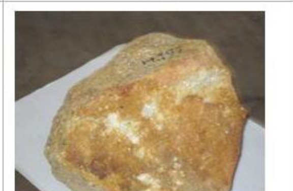
Casiterit với đá biến đổi greizen hoá tại công trình hào H.197
