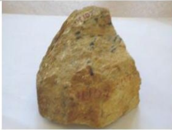
Casiterit với đá biến đổi greizen hoá tại công trình hào H.107
