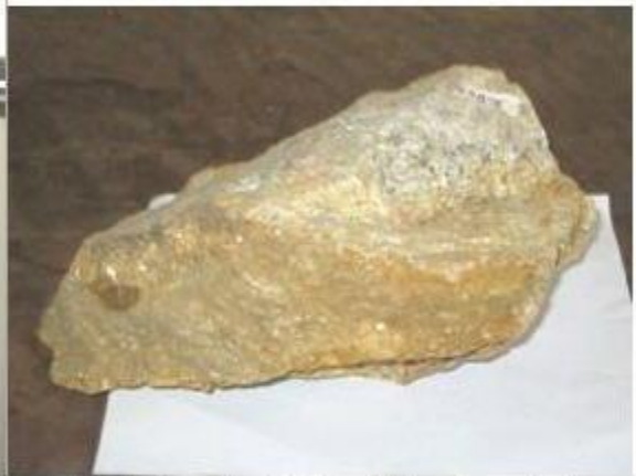
Casiterit với đá biến đổi greizen hoá tại vết lộ V.2951
