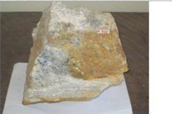
Casiterit với đá biến đổi greizen hoá tại công trình hào H.312
