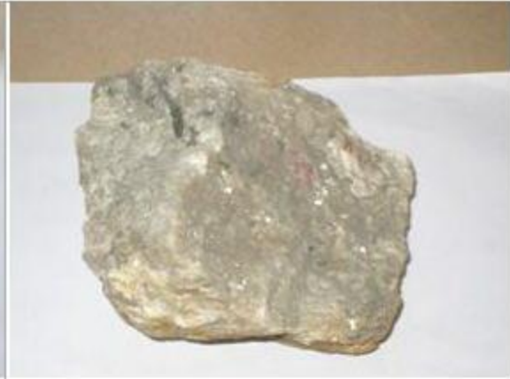
Casiterit với đá biến đổi greizen hoá tại công trình hào H.192
