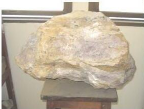
Casiterit với lepidolit trong mạch pegmatoit dạng tàn tích gần H.107
