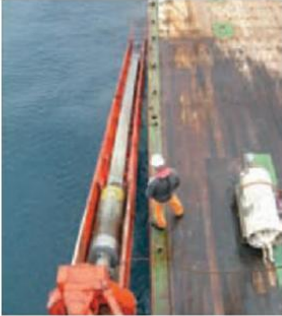
Hình 2a. Ống phóng trọng lực lấy mẫu trầm tích trên tàu Zonne của Đức. Hệ thống này cho phép lấy mẫu tới độ sâu 25 m tính từ mặt đáy biển.
