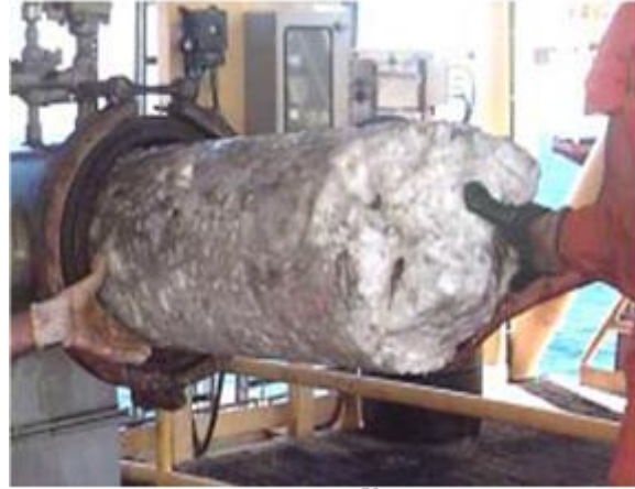
Hình 2a. Ống phóng trọng lực lấy mẫu trầm tích trên tàu Zonne của Đức. Hệ thống này cho phép lấy mẫu tới độ sâu 25 m tính từ mặt đáy biển.
