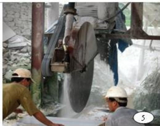
Hình 5. Sử dụng nước để làm mát trong quá trình cưa cắt đá (chụp ngày 22/4/2009 tại Thung Khuộc, Quỳnh Hợp).
