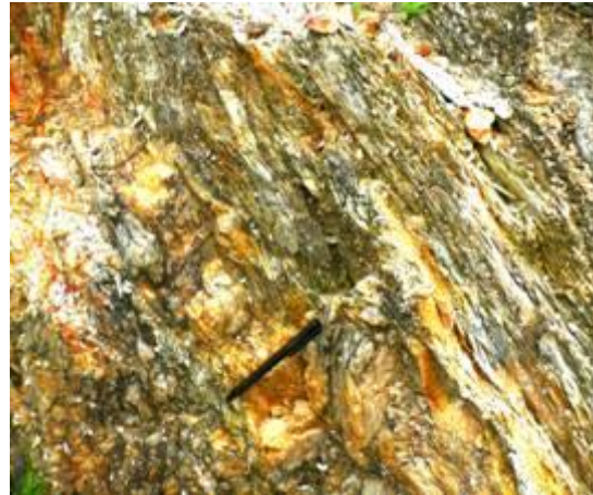
Hình 3. Tập hợp sericit thành dải phân bố song song cùng các ổ, vi mạch thạch anh.
