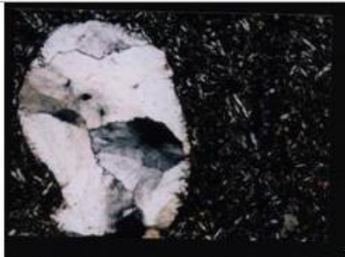
Hình 7. Spilite (apobazan). Hạt nhân có dạng méo mó với thành phần khoáng vật là thạch anh, epidot, chlorit. Lm A.4194, 2 Ni+, 4×10 ×
