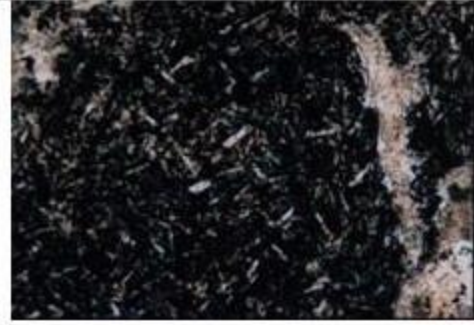
Hình 4. Đá spilite (apobazan). Nền đá gồm vi tinh plagioclas axit, chlorit, quặng, carbonat (tia mạch ố). Lm A.1001, 2 Ni+, 4×10 ×
