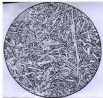
Hình 8. Spilite. Hạt nhân có dạng đẹp với thành phần khoáng vật là thạch anh. Lm A.4194, 2 Ni+, 4×10 ×
