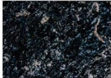
Hình 8. Spilite. Hạt nhân có dạng đẹp với thành phần khoáng vật là thạch anh. Lm A.4194, 2 Ni+, 4×10 ×
