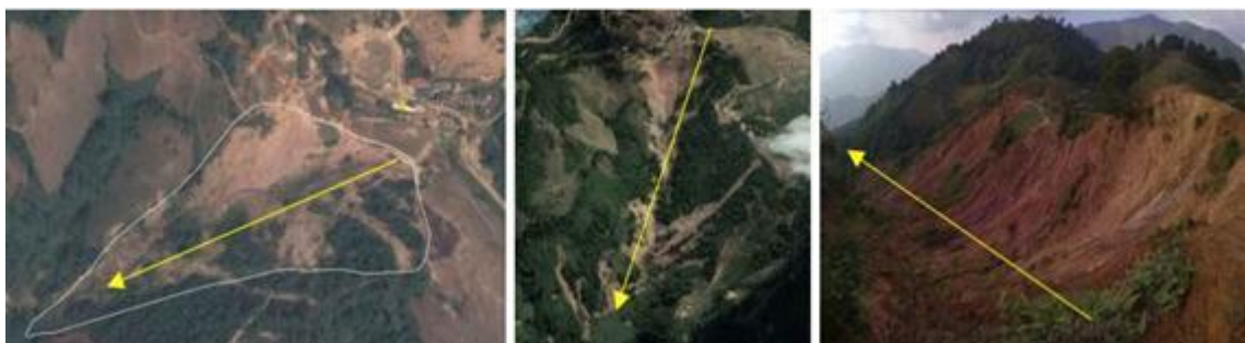
Hình 8. Khối trượt có quy mô đặc biệt lớn xảy ra tại bản Sài Khao, xã Tam Chung được giải đoán từ ảnh Google Earth chụp ngày 12/10/2018 (hình trái), được hiệu chỉnh lại trên ảnh Google lập thể (hình giữa) và được kiểm chứng từ khảo sát thực địa (hình phải).
