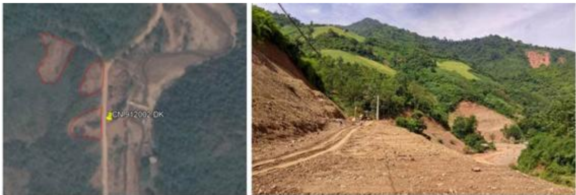
Hình 9. Ba khối trượt giải đoán từ ảnh Google Earth - nằm tại một khu vực sườn dốc thuộc bản Poọng - không thể quan sát được các dấu vết của hoạt động trượt lở đất đá tại thời điểm kiểm chứng thực địa, do sườn dốc cũ đã bị san gạt, bóc hết lớp đất đá trên bề mặt.
