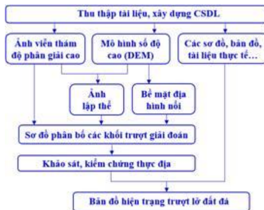
Hình 3. Quy trình thực hiện ứng dụng phân tích địa hình trên mô hình lập thể số và giải đoán ảnh viễn thám độ phân giải cao để thành lập bản đồ hiện trạng trượt lở đất đá.
