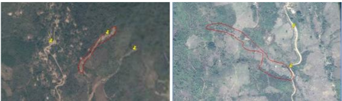
Hình 11. Một số khối trượt giải đoán từ ảnh Google Earth đã được kiểm chứng thực địa, và được xác nhận đã gây ra lũ bùn đá, làm ảnh hưởng tới khu vực dân cư ở phía dưới sườn núi thuộc bản Suối Lóng vào mùa mưa năm 2018.
