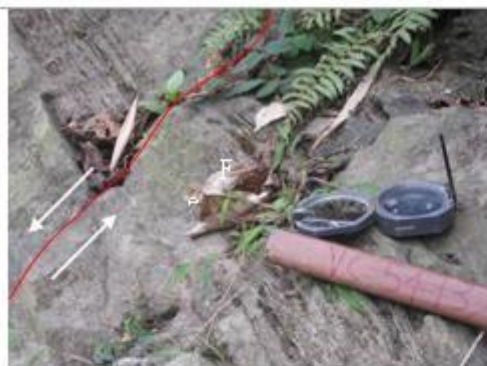
Hình 2. Đứt gãy trượt bằng trái làm dịch chuyển vỉa quặng sắt quarzit magnetit (Fe - vỉa quặng sắt)
