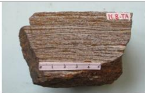
Hình 4. Quarzit magnetit cấu tạo phân dải tại khu Tân An.
