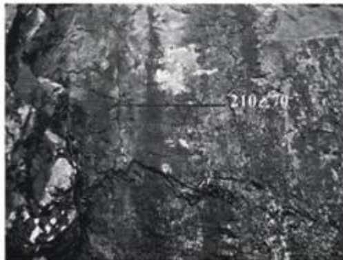
Ảnh 2b. Mặt trượt thuận cắt đới dập vỡ (Ảnh: Chu Văn Ngợi, 2014).
