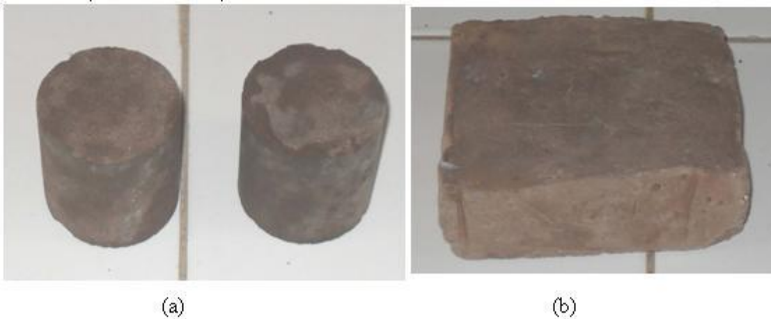
Hình 4. Sản phẩm geopolimer sản xuất từ puzzolan tự nhiên: a) Theo phương pháp nén ép bán khô; b. Theo phương pháp rót khuôn.
