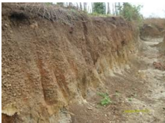
Hình 6. Lớp vỏ phong hóa rất mỏng, lộ ra đới đá gốc và đới bán phong hóa.
