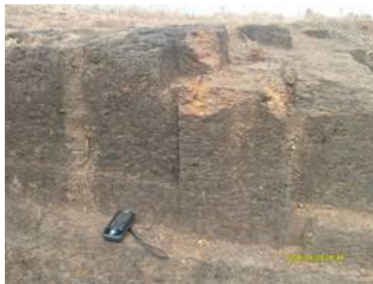
Hình 9. Đới laterit được nhân dân khai thác làm vật liệu xây dựng.
