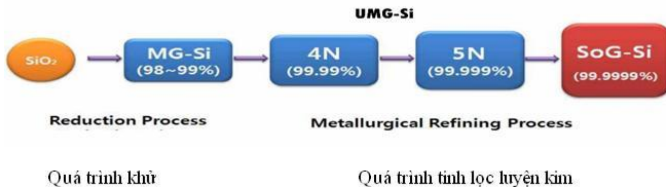
Hình 1. Giản đồ quá trình sản xuất SoG Si
