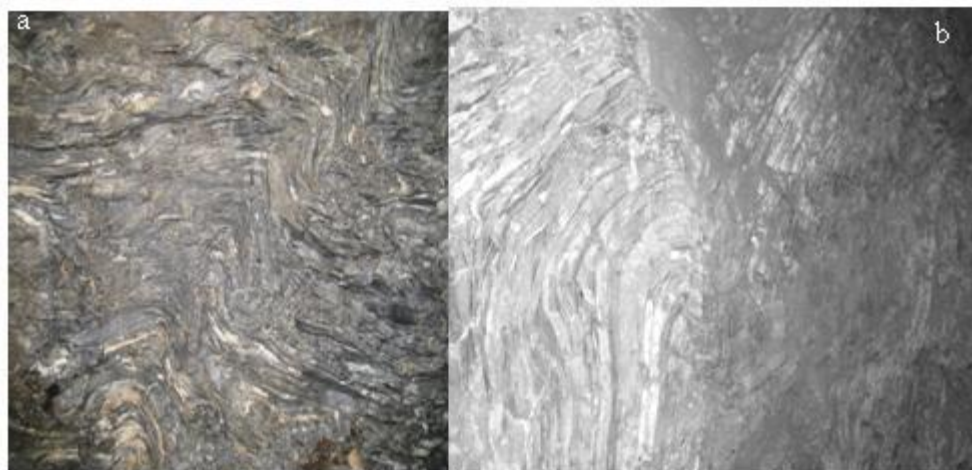
Hình 4. Vi uôn nếp ở mỏ Bắc Lũng Hoài: a) cao trình 733 m, b) cao trình 697 m [5]
