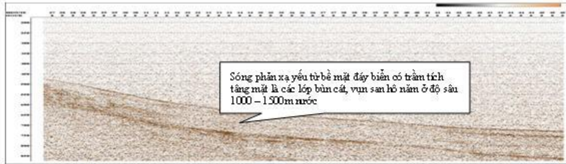
Hình 2. Sóng phản xạ yếu từ bề mặt đáy biển đặc trưng cho các lớp bùn cát vụn san hô nằm ở độ sâu 1000-1500 m nước.
