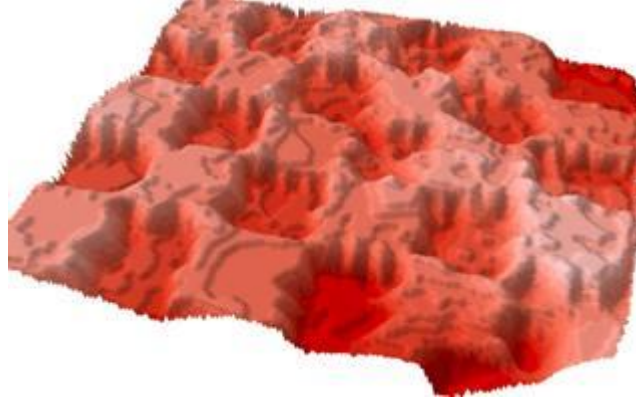
Hình 4. Sơ đồ khối biến đổi địa hình đáy biển do khai thác VLXD đáy biển với kích thước ô mạng là 1 \times 1 km tới độ sâu 5,0 m.
