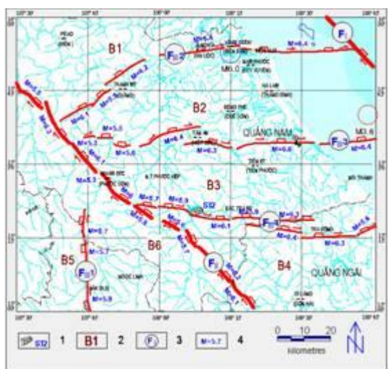
Hình 4. Động đất cực đại có thể xảy ra dọc các phân đoạn đứt gãy khu vực công trình thủy điện ST2 và kế cận (1, 2, 3- Như chú giải trong hình 1; 4- Động đất cực đại có thể xảy ra trong từng đứt đoạn của đứt gãy)
