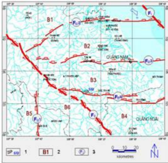
Hình 1. Khối địa động lực hiện đại khu vực công trình thủy điện ST2 và kế cận (1- Đập ST2; 2- Khối địa động lực; 3- Đứt gãy).
