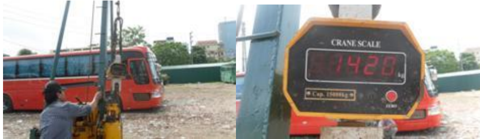
Ảnh 7. Thử tải ở trạng thái khoan nghiêng -75^{\circ} (Nguồn: Nguyễn Chí Kiên, 2012).
