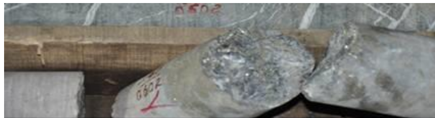
Ảnh 1. Barit-đất hiếm dạng ổ xâm tán và lấp đầy khe nứt có khoáng hoá sulfur.
