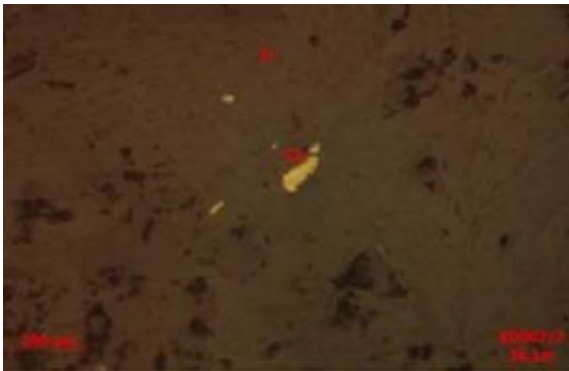
Ảnh 5. Chalcopyrit (Cp) hạt tha hình xâm tán cùng đất hiếm (Tr) trên nền khoáng vật tạo đá
