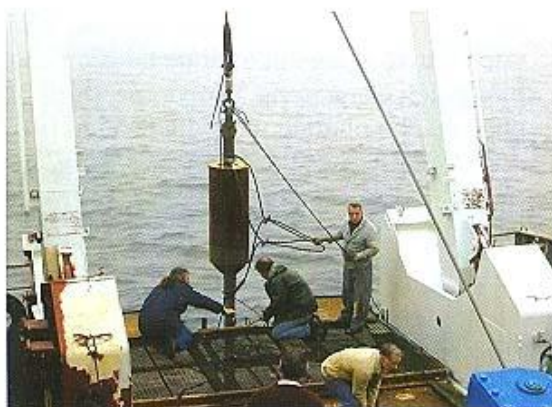
Ảnh 1. Lấy mẫu trầm tích biển bằng ống phóng trọng lực loại lớn.
