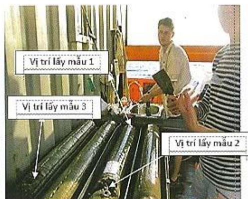
Ảnh 2. Mẫu lõi phóng thu được và các vị trí lấy mẫu phân tích.
