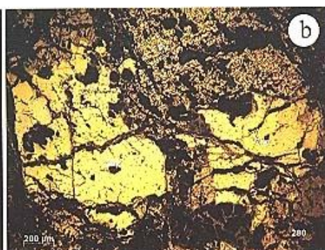
Ảnh 7. Cấu tạo xuyên cắt. (a): chalcopyrit xuyên cắt vào pyrotin; (b): pyrit xuyên cắt vào chalcopyrit. Pyr: pyrotin; Py: pyrit; Chp: Chalcopyrit.
