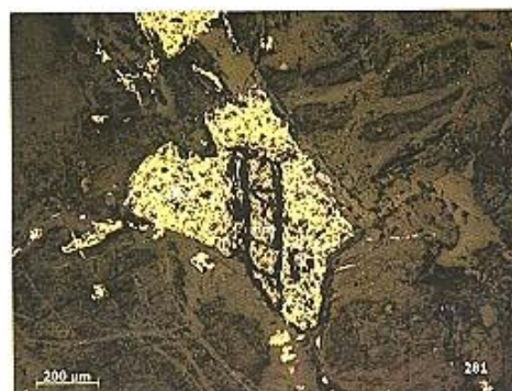
Ảnh 5. Các khoáng vật quặng chủ yếu trong đá siêu mafic khu vực thành phố Cao Bằng. Py: Pyrit; Pyr: pyrotin; Pld: Penlandit; Hm: Hematit; Chp: chalcopyrit.
