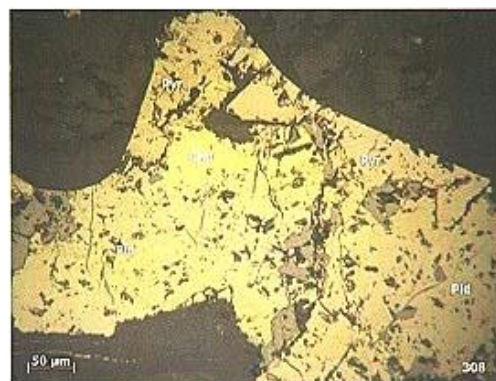
Ảnh 9. Quặng đồng sinh với khoáng vật olivin. Pyr: pyroxen; Chp: chalcopyrit; Pld: pentadit; Hm: hemantit.
