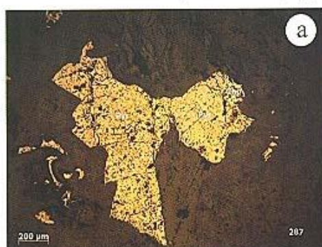
Ảnh 7. Cấu tạo xuyên cắt. (a): chalcopyrit xuyên cắt vào pyrotin; (b): pyrit xuyên cắt vào chalcopyrit. Pyr: pyrotin; Py: pyrit; Chp: Chalcopyrit.
