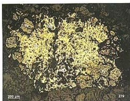
Ảnh 5. Các khoáng vật quặng chủ yếu trong đá siêu mafic khu vực thành phố Cao Bằng. Py: Pyrit; Pyr: pyrotin; Pld: Penlandit; Hm: Hematit; Chp: chalcopyrit.
