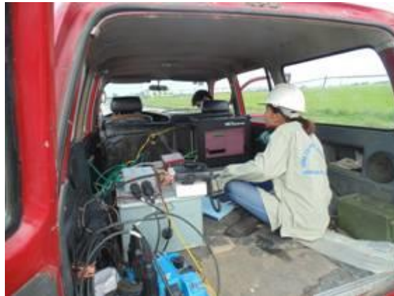
Ảnh 8. Trạm máy địa chấn SERCEL 428 XL 1000 kênh (Pháp) đang làm việc tại Thái Bình (năm 2014).
