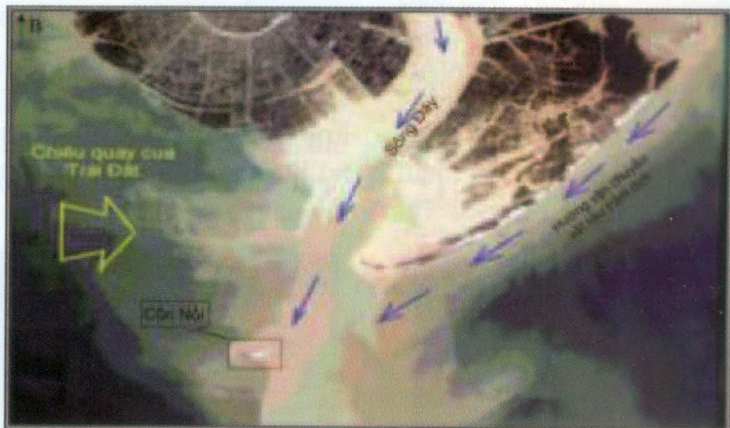
Hình 3. Vật liệu trầm tích từ cửa Đáy di chuyển dọc đường bờ từ phía đông bắc xuống (Nguồn ảnh vệ tinh: Quickbird chụp năm 2008) [1].
