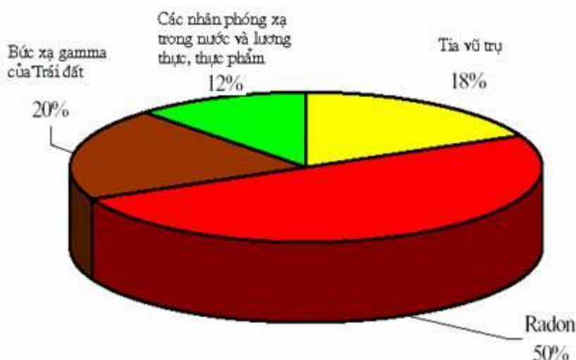
Hình 1. Sự đóng góp các thành phần liều tương đương từ các nguồn phóng xạ tự nhiên.
