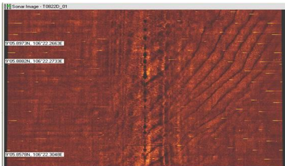
Hình 1. Đoạn băng ghi sonar tuyến T0822D thể hiện sóng cát trên đáy biển vùng biển ven bờ Sóc Trăng, 2008.
