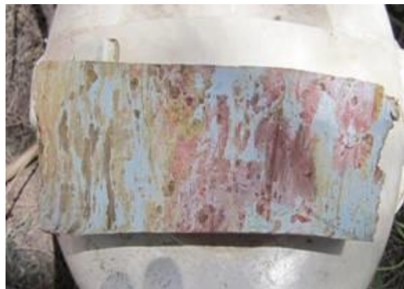
Ảnh 3. Tầng sét nguồn gốc biển bị laterit hóa mạnh (ở độ sâu từ 38,5 - 54,5 m).
